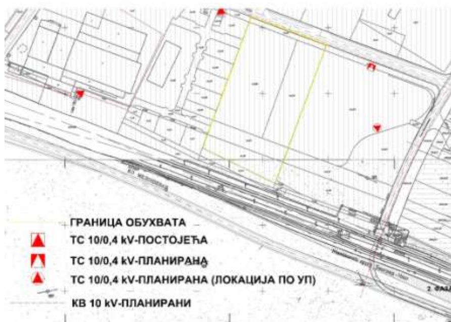
Илустрација 74: Електроенергетска мрежа
